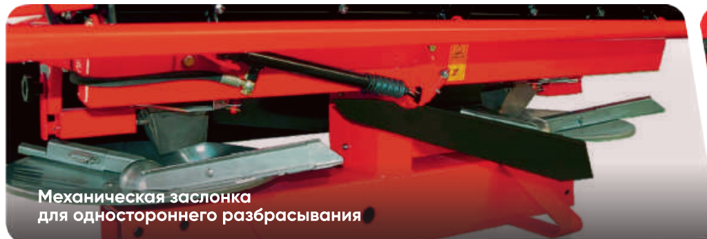
Разгрузочные воронки из нержавеющей стали
