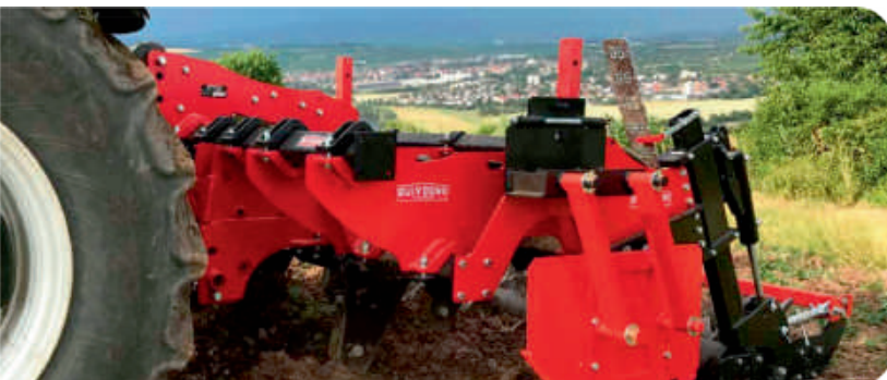
Агрессивное положение лап с центральным режущим ножом
